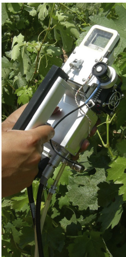
Pinza de IRGA midiendo intercambio de gases en hoja expuesta.
