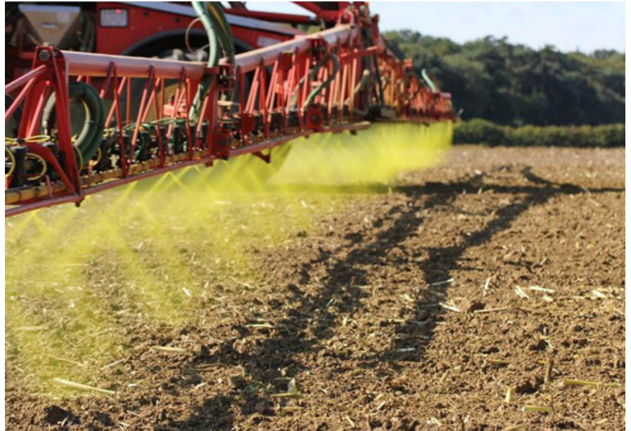
Aplicación de herbicida en pre-emergencia con boquilla de doble abanico (Fuente: Syngenta UK).
