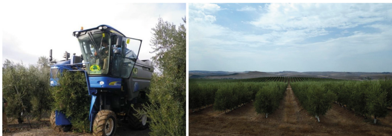
FIGURA 3 La recolección mecánica del olivo en continuo con vendimiadoras cabalgantes (a) y la adaptación casual de la variedad Arbequina iniciaron el desarrollo de las primeras plantaciones de olivar superintensivo (b)
