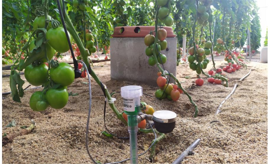
Invernadero experimental donde se realizó el ensayo de mezclas de aguas y manejo del riego con electrotensiómetros.
